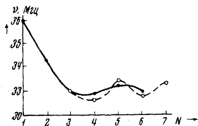
Рис. 10. Зависимость от N частоты ЯКР атомов Cl в соединениях \text{Cl}-(\text{CH}_2)_N-\text{Cl} (сплошная линия — экспериментальная, прерывистая — вычисленная)
